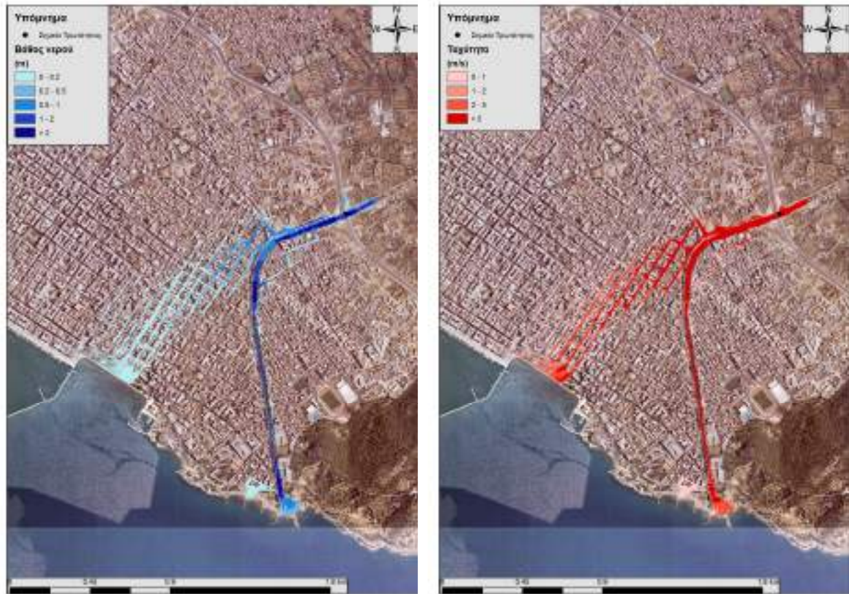
Εικόνα 6.35: Σχηματική απεικόνιση έκτασης βάθους και ταχυτήτων ροής πλημμύρας του ρ. Άναβρος για περίοδο επαναφοράς T=50 ετών
