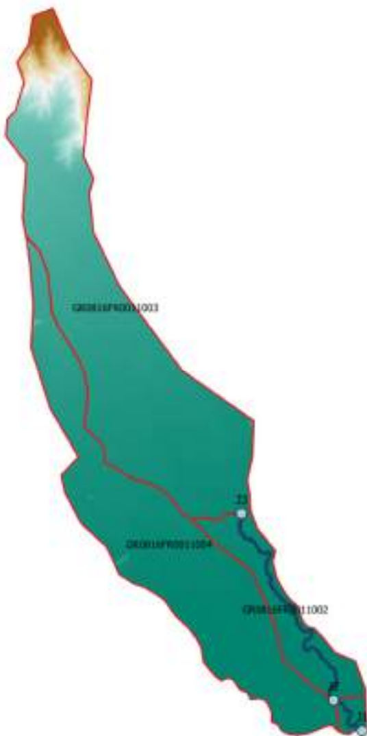
Εικόνα 7.38: Χάρτης περιοχής μελέτης, στον οποίο απεικονίζεται η σχηματοποίηση των κόμβων και κλάδων του υδρογραφικού δικτύου και των υπολεκανών
