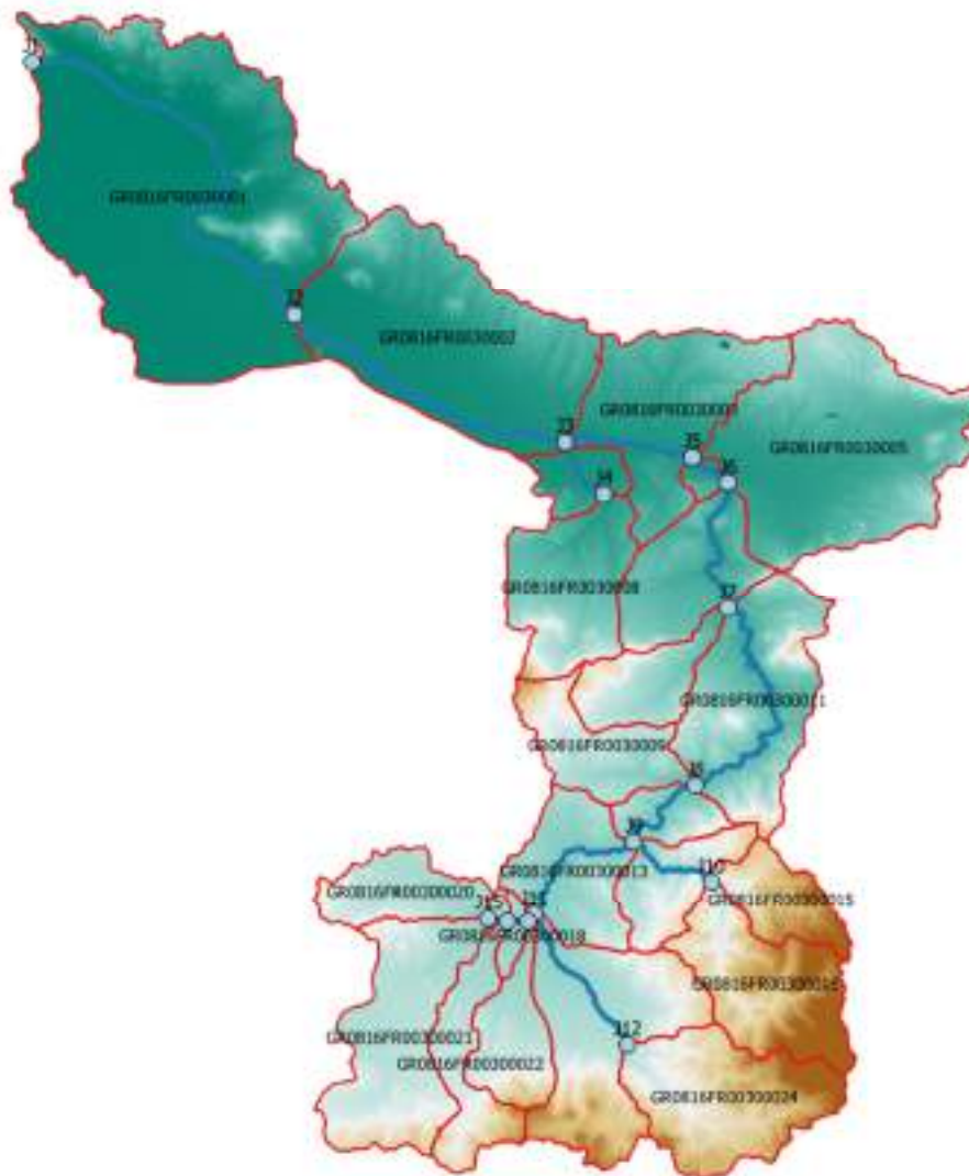
Εικόνα 7.6: Χάρτης περιοχής μελέτης, στον οποίο απεικονίζεται η σχηματοποίηση των κόμβων και κλάδων του υδρογραφικού δικτύου και των υπολεκανών
