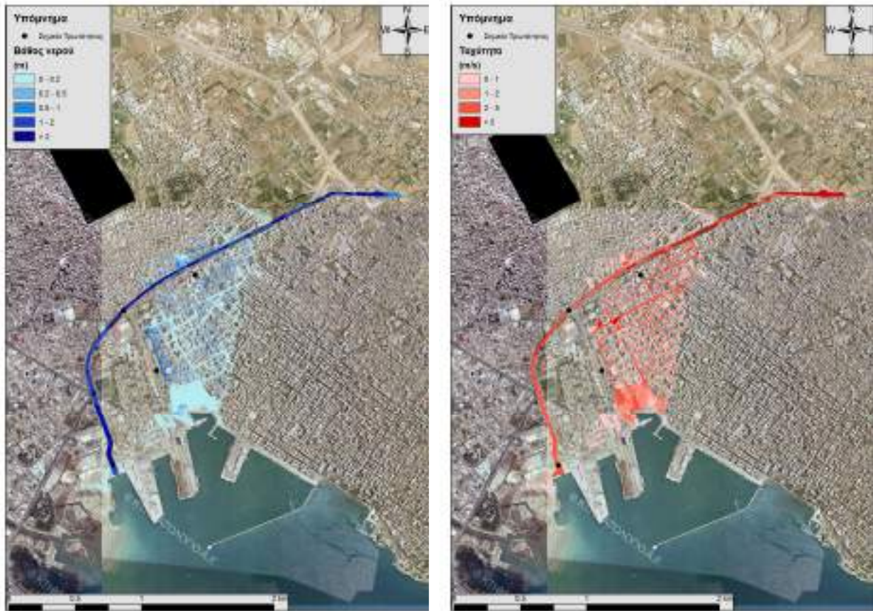
Εικόνα 6.32: Σχηματική απεικόνιση έκτασης βάθους και ταχυτήτων ροής πλημμύρας του ρ. Κρασιδώνα για περίοδο επαναφοράς T=100 ετών
