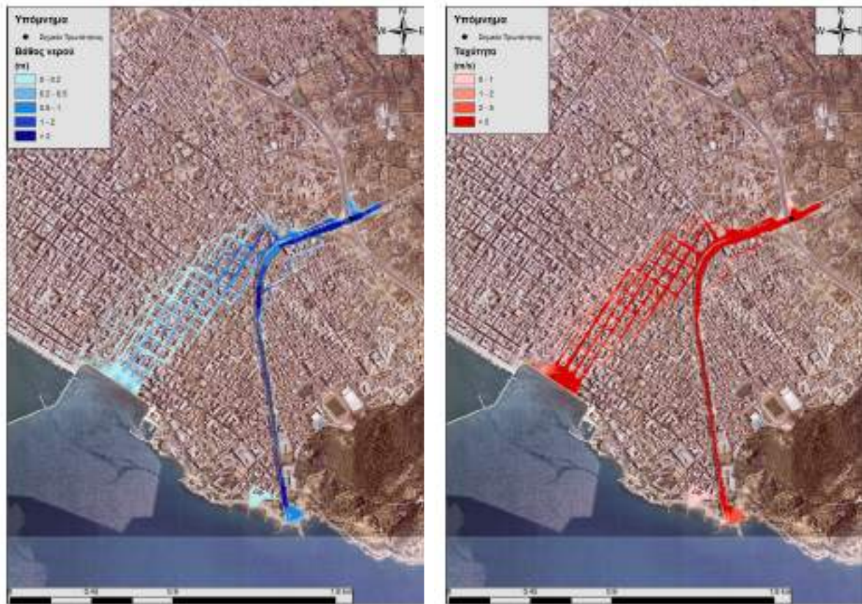
Εικόνα 6.36: Σχηματική απεικόνιση έκτασης βάθους και ταχυτήτων ροής πλημμύρας του ρ. Αναβρος για περίοδο επαναφοράς T=100 ετών
