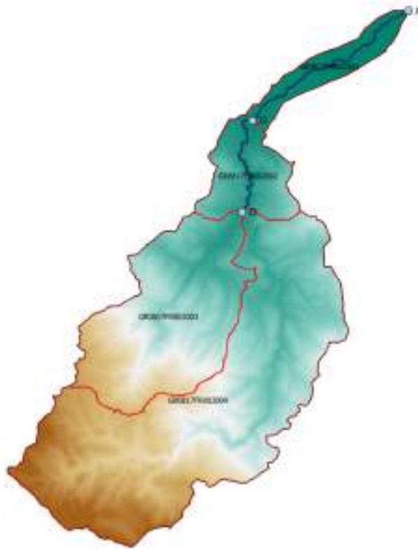
Εικόνα 6.6: Χάρτης περιοχής μελέτης, όπου απεικονίζεται η σχηματοποίηση των κόμβων και κλάδων του υδρογραφικού δικτύου και των υπολεκανών
