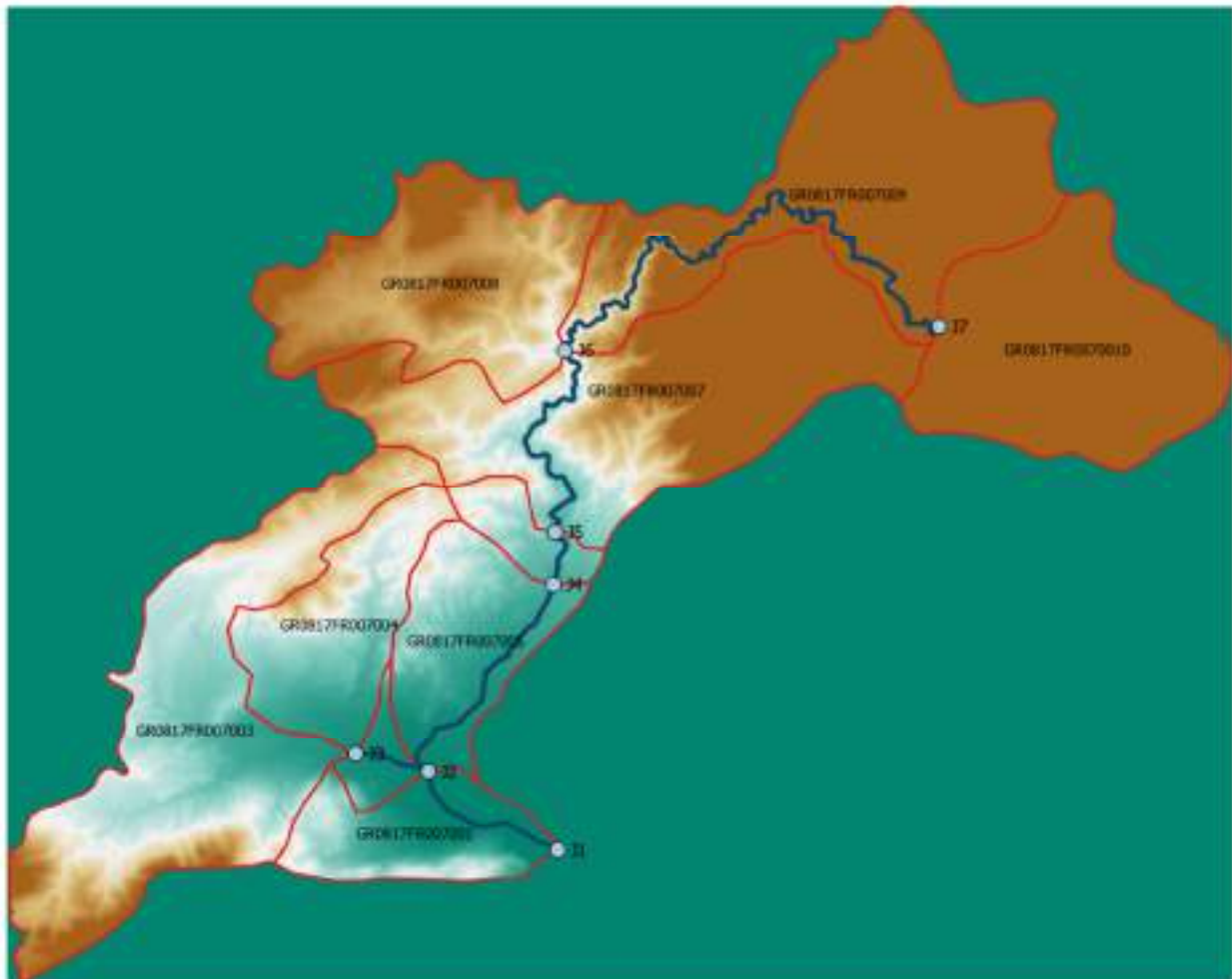
Εικόνα 6.26: Χάρτης περιοχής μελέτης, όπου απεικονίζεται η σχηματοποίηση των κόμβων και κλάδων του υδρογραφικού δικτύου και των υπολεκανών
