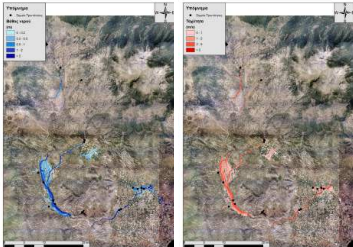
Εικόνα 7.47: Σχηματική απεικόνιση έκτασης βάθους και ταχυτήτων ροής πλημμύρας του ρ. Τιταρήσιου για περίοδο επαναφοράς T=50 ετών
