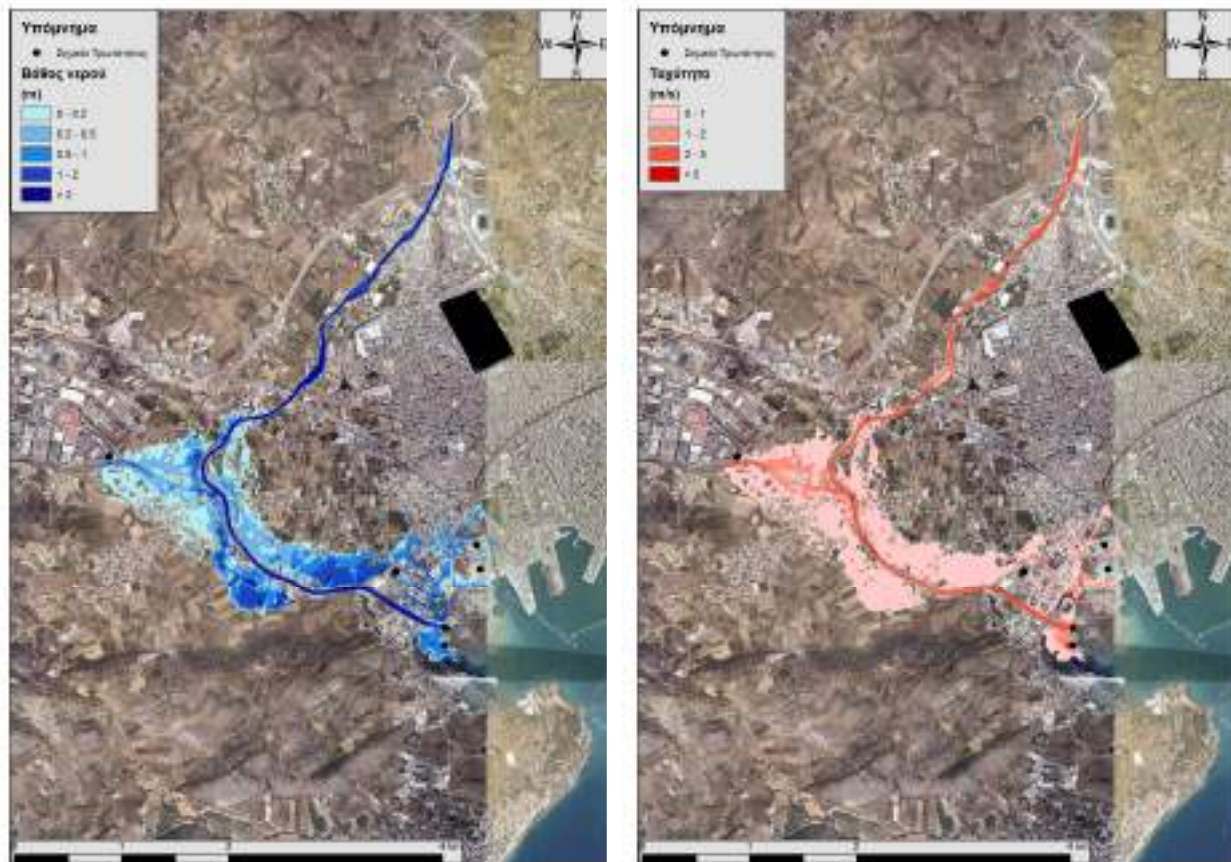
Εικόνα 6.27: Σχηματική απεικόνιση έκτασης βάθους και ταχυτήτων ροής πλημμύρας του ρ. Ξηριάς Βόλου για περίοδο επαναφοράς T=50 ετών
